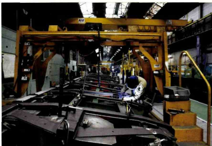
La partie chaudronnerie, exécutée sur une voiture de TGV à Belfort.
