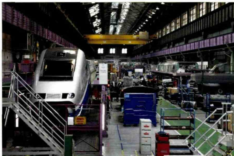
Un atelier de finition pour l'assemblage d'une motrice de TGV sur le site de Belfort.
